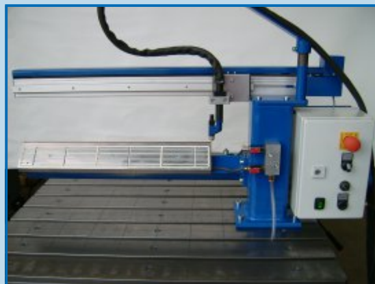
Сварка угловыми швами на вакуумных балках
